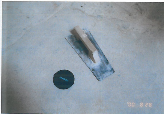
3 石灰モルタルの塗布に用いる鏝
