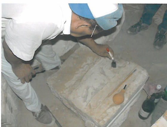
4 石灰岩の脱塩作業風景 2
