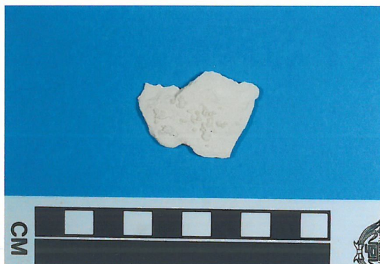
2 トウラ産白色石灰岩の剥離片表面に析出した 塩類 (試料番号 104)
