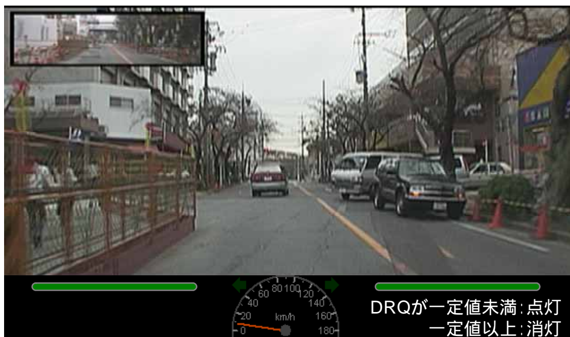
Fig.8-2-2 安全ランプ条件時の運転模擬画面
