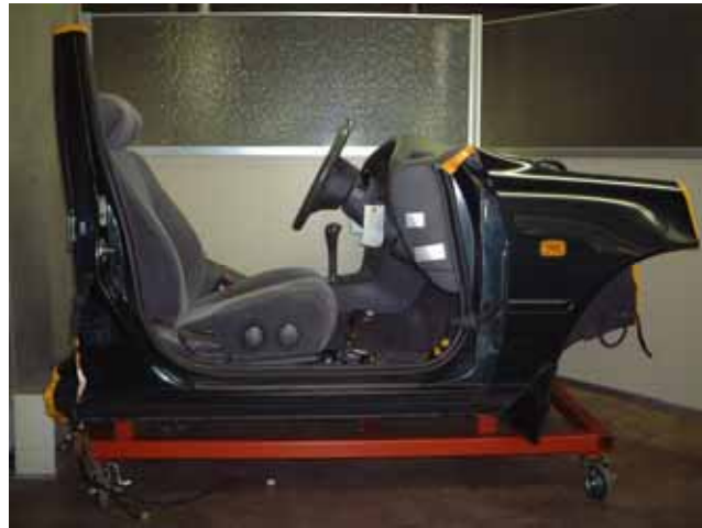
Fig.5-3-2 TEDDY のベースとした実車カットボデー
