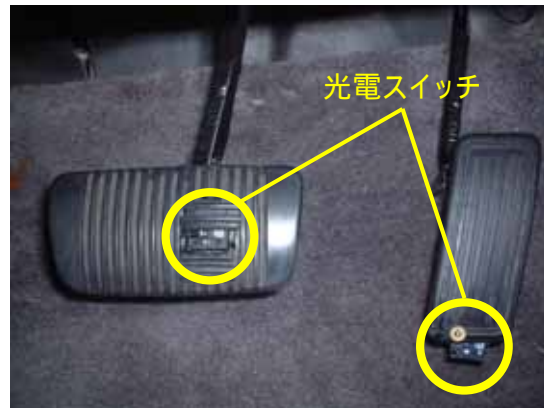
Fig.5-3-8 ペダルへの足の構え取得のための光電スイッチの取り付け
