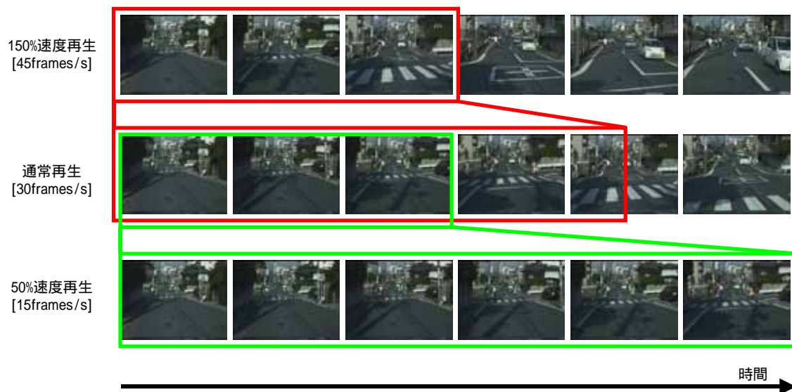
Fig.5-4-3 実写ビデオの再生速度制御による車速変化の模擬
