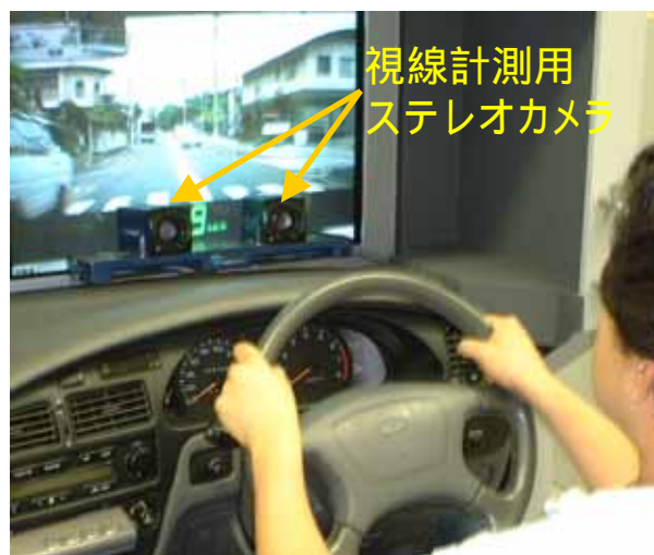
Fig.5-3-11 TEDDY に搭載した視線計測装置(faceLAB)
