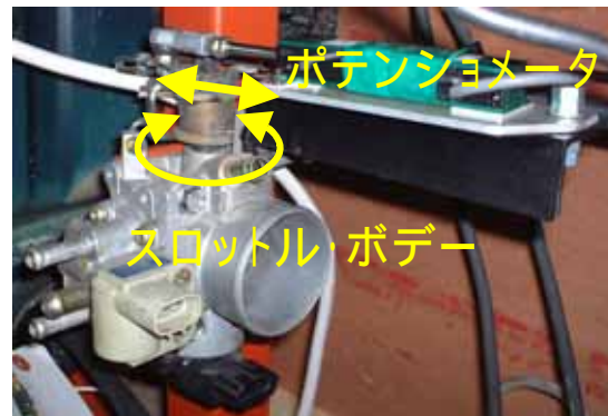
Fig.5-3-5 アクセル・ストローク取得のためのポテンシヨメータの取り付け
