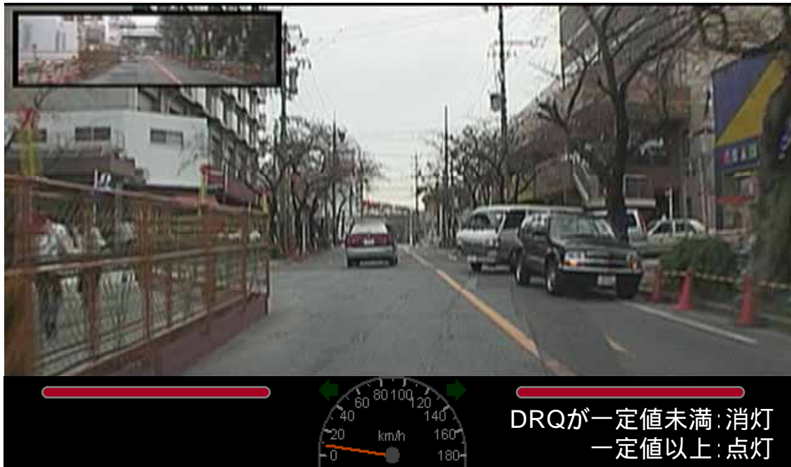
Fig.8-2-3 危険ランプ条件時の運転模擬画面
