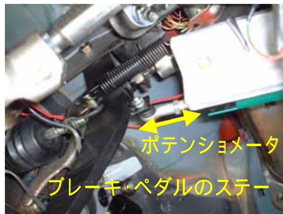
Fig.5-3-6 ブレーキ・ストローク取得のためのポテンシヨメータの取り付け
