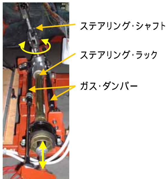
Fig.5-3-9 ステアリングの反力生成機構
