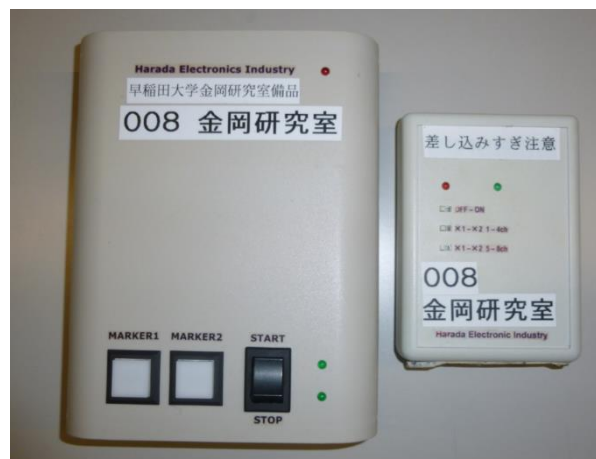
図9. 無線筋電テレメーター
