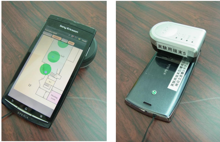
図 2.4 Android 端末画面と測位モジュールの接続方法
