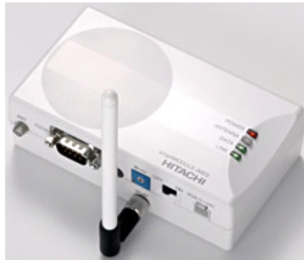
図 2.1 製品化した IMES 送信機外観
