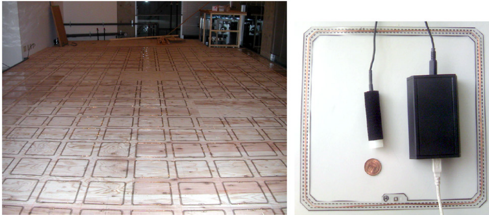
図 1.11 床面 RFID タグ設置の様子 (左) と RFID タグとタグリーダ (右)
