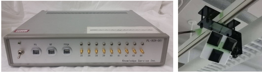
図 5.11 9チャンネル送信機（左）と角度を調整可能な送信アンテナ（右）
