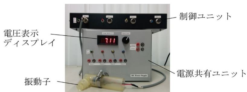
図 5.1 振動刺激提示装置の概観
