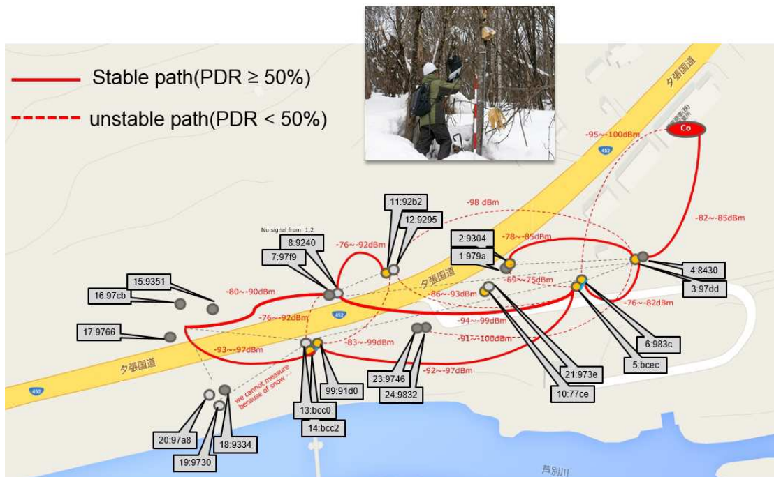
図 4.54: エリア 5 中継ノード間の通信品質
