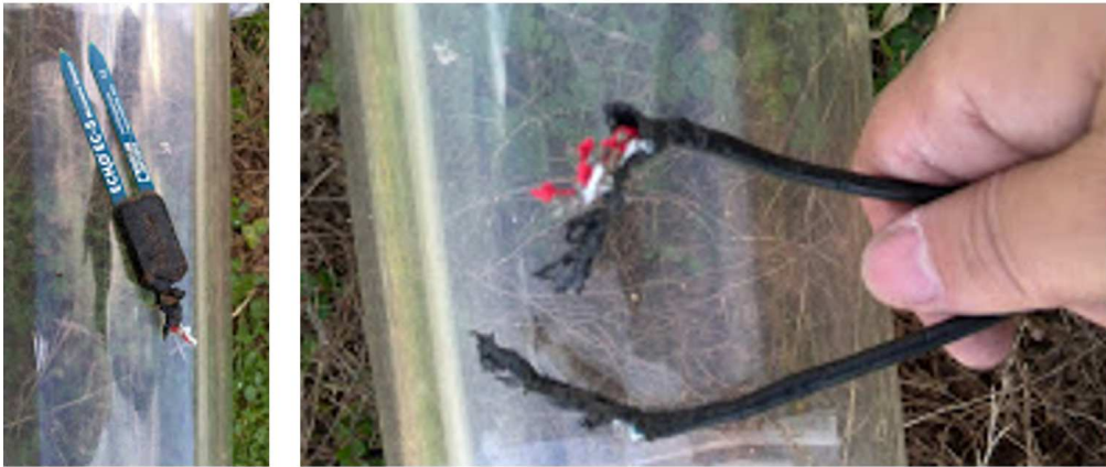
図 4.46: エリア 4 獣害 (Animal injury) によるシステムトラブル
