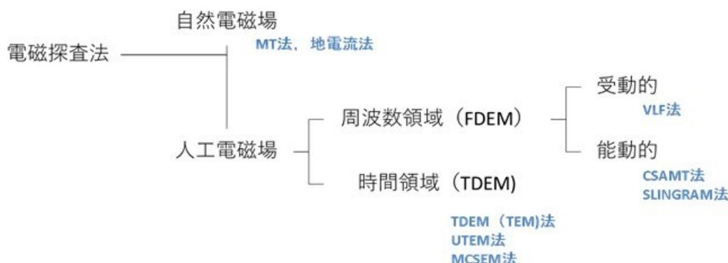
付図 1-1 電磁探査法の分類の例
