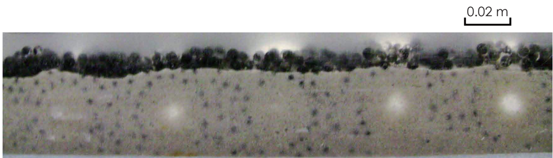
写真-5 M 粒子の比率 R_M が 0.6 の場合の初期状態 (側方より撮影)
