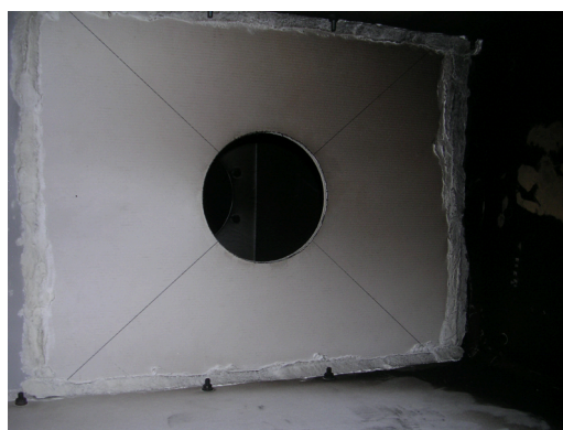
写真 2-10 小型集煙フードのチャンバーの仕切り板と開口 (フード下方から撮影)
