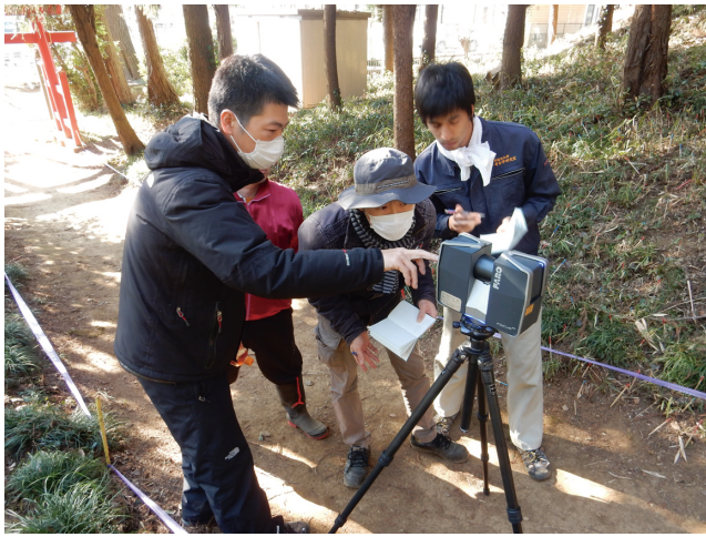
写真6 FARO を用いた計測作業
