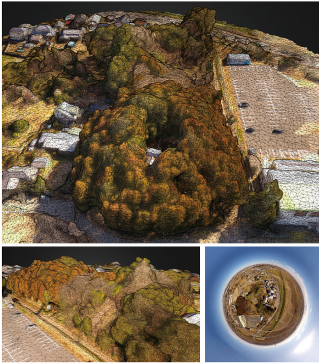
図 11 UAS の空撮画像から生成したプロダクト (上) テクスチャー付き 3D モデル。黒線は 3D ポリゴンのフェイス境界線（ワイヤフレーム）を示す。北より。 (左下) 同、南西より。写真 12 とほぼ同じ視点。 (右下) 空撮画像を合成し作成した 360° 画像。 ※以下の URL より画像は閲覧可能。 https://skfb.ly/66CoV https://www.skypixel.com/photos/9f06bd5a-b2de-473d-bc09-321052e95f2c
