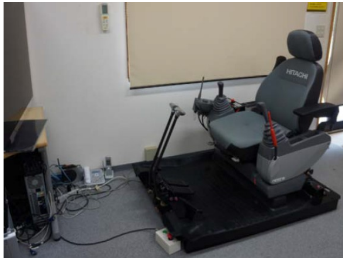
図 2.9 搭乗タイプの操作インターフェース
