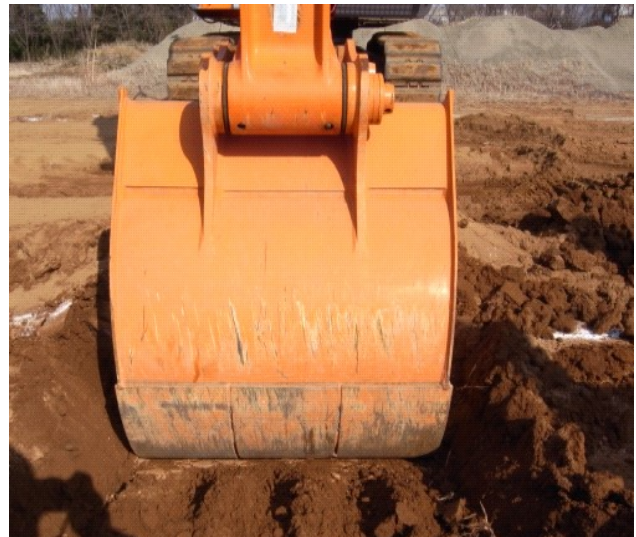
図 2.3 掘削時のバケット先端部の状況 (2013.3 茂木撮影)
