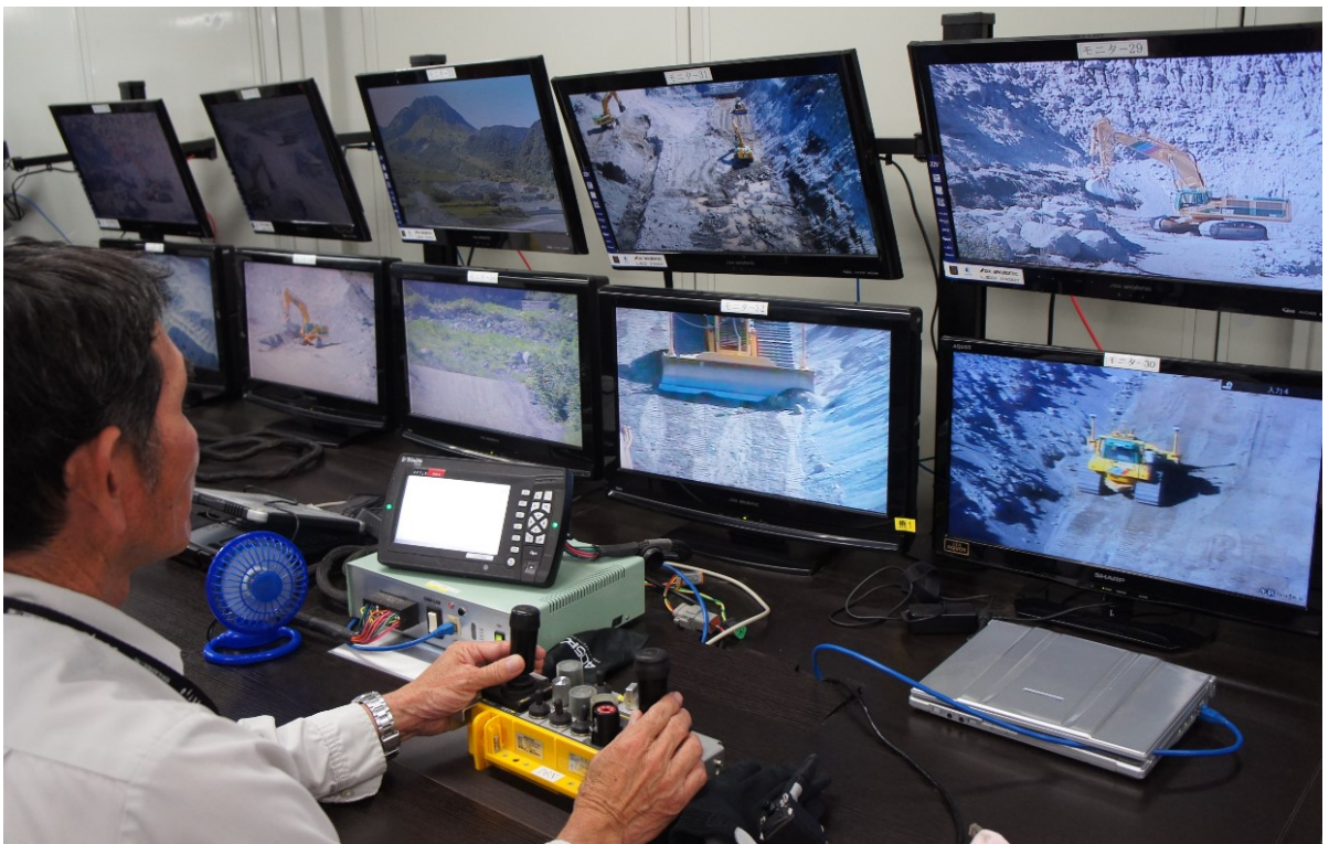
図 1.3 遠隔操作による建設機械の操作状況（2014.9 茂木撮影）
