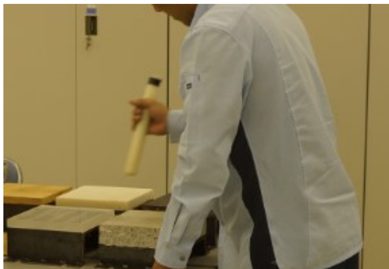
図 5.9 実験2における探索棒を用いた供試体の事前把握
