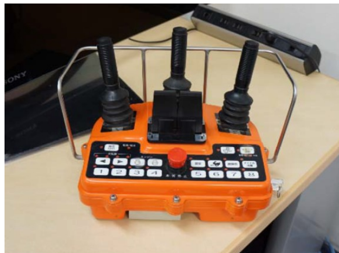
図 2.10 遠隔操作用ジョイスティックタイプのインターフェース
