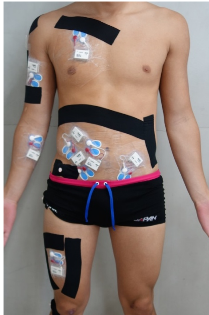
図 4 筋電計の防水加工
