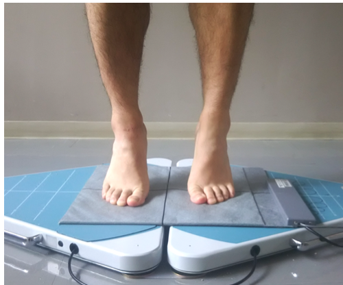
図 9：ツイングラビコーダー GP-6000，MD-1000 を用いた足底圧中心の計測．図はカーフレイズ位．
