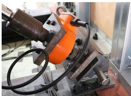
写真 5.7 1層ダンパ床側接合部
