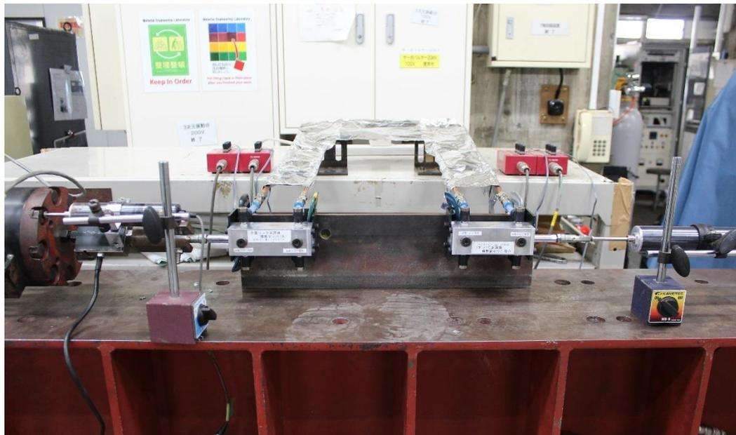
写真 3.3 流体加熱時の試験体設置状況
