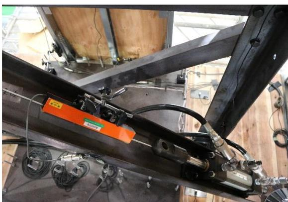
写真 5.6 ピストン変位の計測方法
