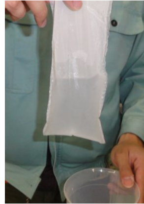
図 3-2-9 ナイロン製ティーバックと吸水倍率測定状況
