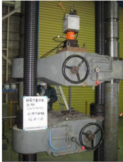
図 4-5-6 鉄筋引き抜き試験状況
