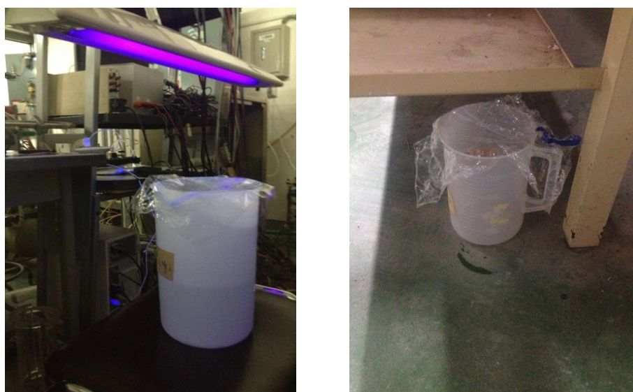
図4-6-7 放置時の状態（左：紫外線照射 右：暗室）
