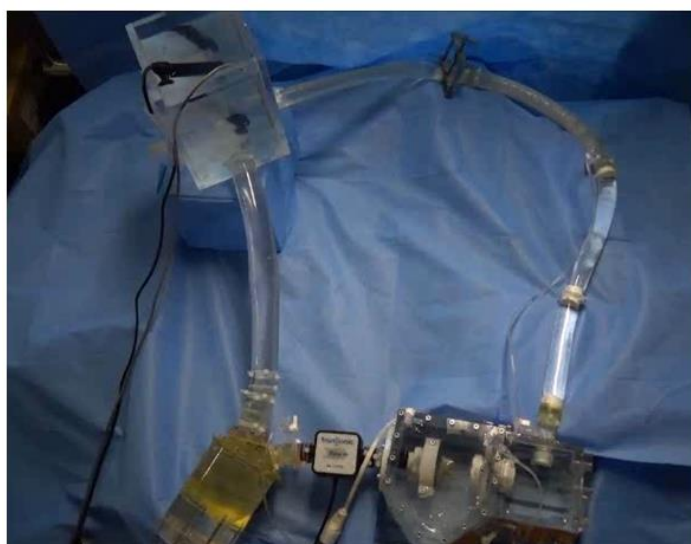
図 17. 拍動循環試験装置と試験条件。
