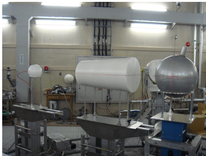
図 5.24 6 インチボナー球検出器による中性子フルエンス測定
