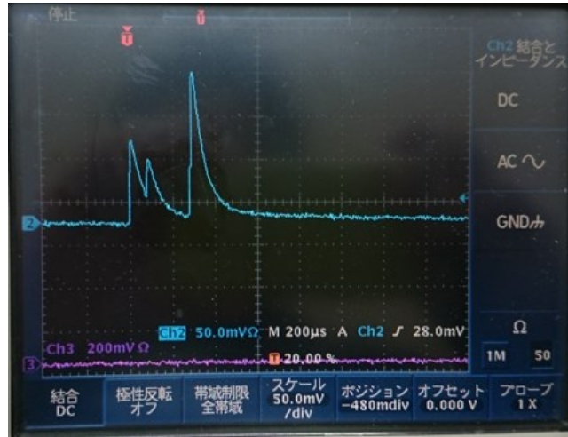
図 4.10 ボナー検出器の前増幅器出力信号波形
