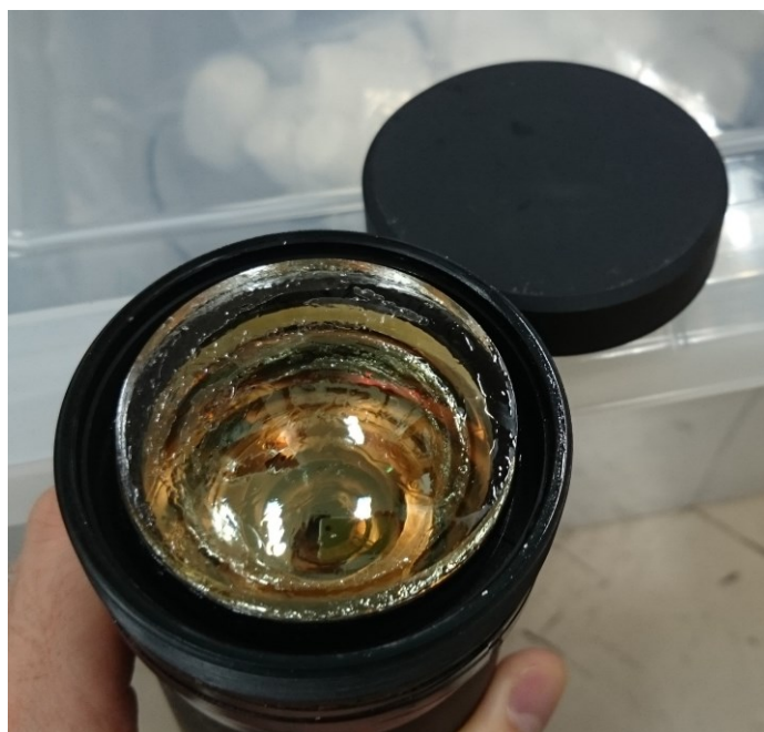
図 2.27 GS20 検出器の PMT 接続部周辺の構造
