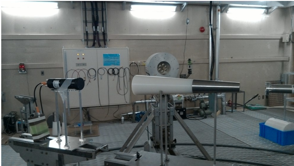
図 2.25 GS20 検出器の 144 keV 中性子応答測定体系
