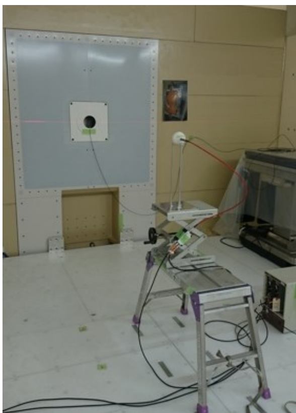
図 4.8 ボナー球検出器による測定
