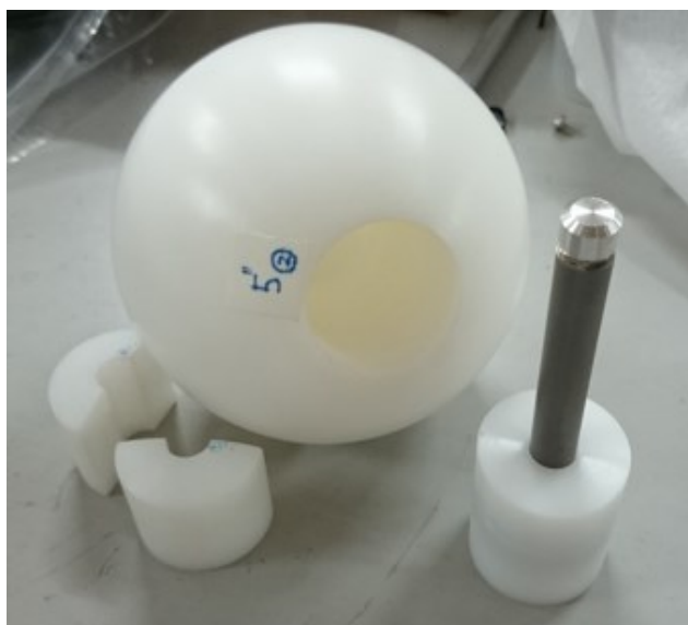
図 3.4 ボナー球検出器の SP9 挿入構造
