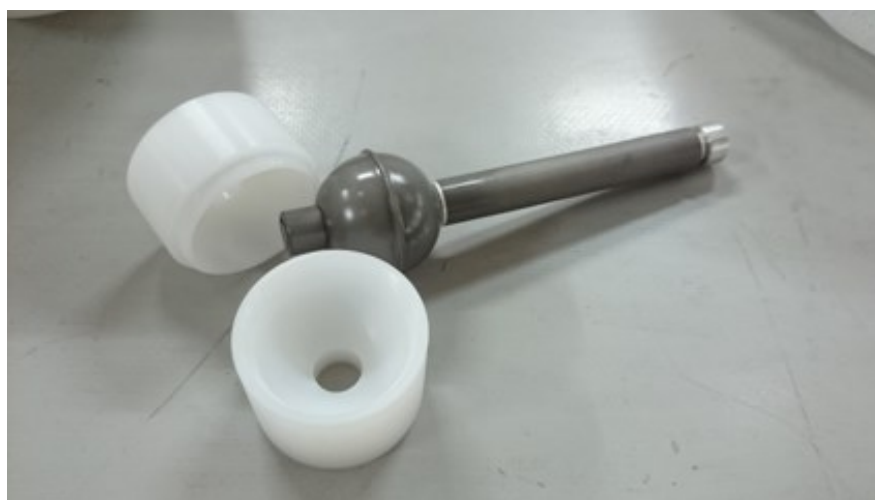
図 3.3 球形 ^3\text{He} 比例計数管 SP9 とアタッチメント
