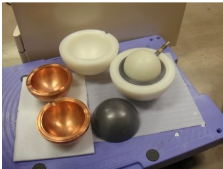
図 3.5 高エネルギー中性子向けの金属層を含むボナー球検出器
