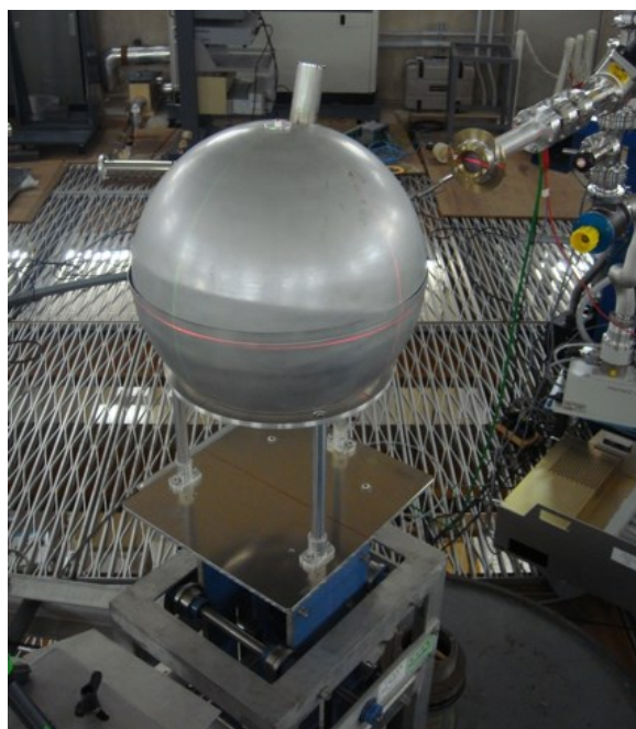
図 5.3 重水減速 ^{252}\text{Cf} 中性子源アセンブリ
