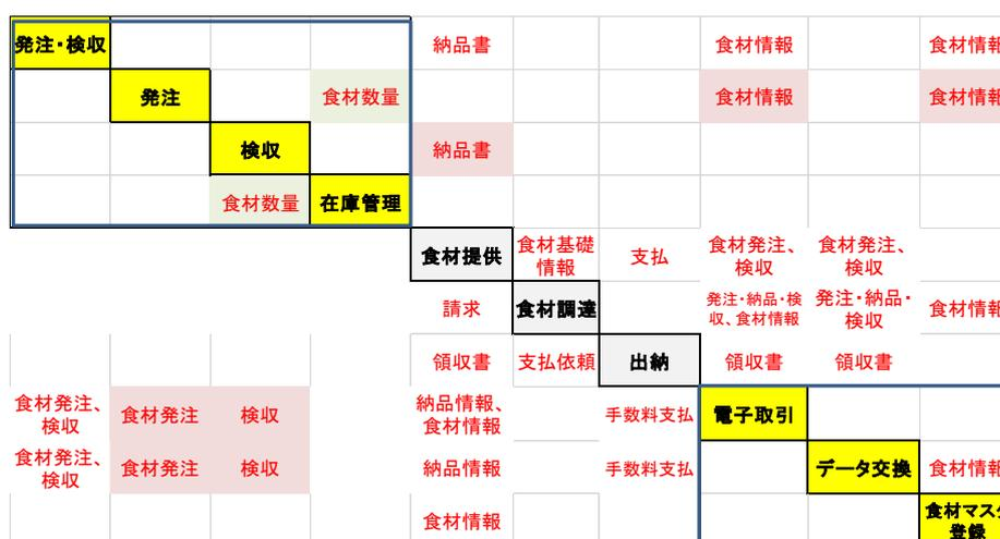
図 6.5 複数の機能を分解した連携図(MDM)
