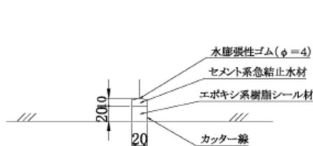
図 3-3-4 Uカット・注入方式<sup>3)</sup>
