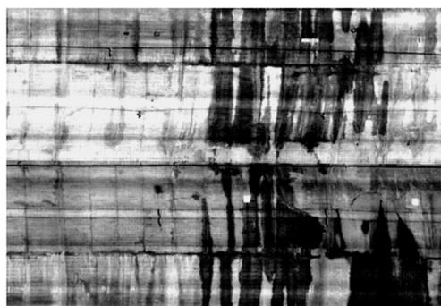
写真 2-3-2 覆工展開画像の例 (ラインセンサカメラ)<sup>21)</sup>
