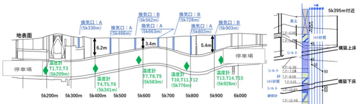
図 7-2-1 トンネル内環境測定区間，温度計設置箇所，および地質柱状図
