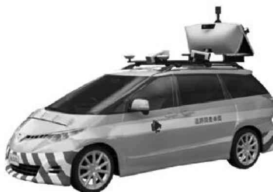
写真 2-3-3 レーザーによる三次元点群データシステム
