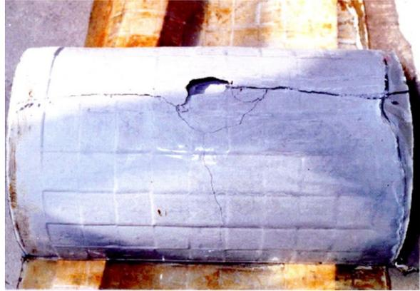
写真 2-2-6 押抜きせん断されたトンネル覆工
