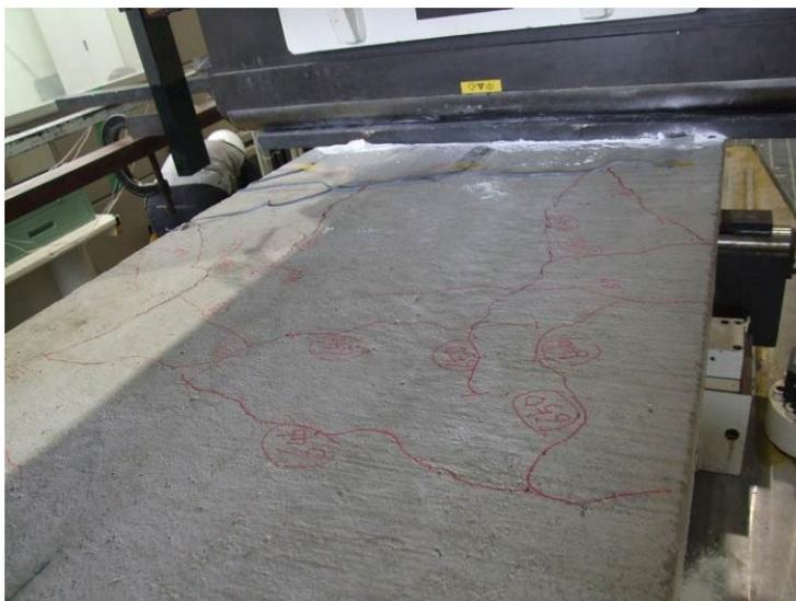
図 3-3-3 B-1 最大せん断力時のフランジのひび割れ状況
