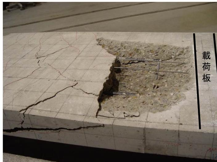
図 2-3-7 T-5 フランジの破壊面
