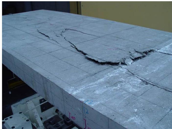
図 2-3-9 T-1 試験体のフランジ破壊状況
