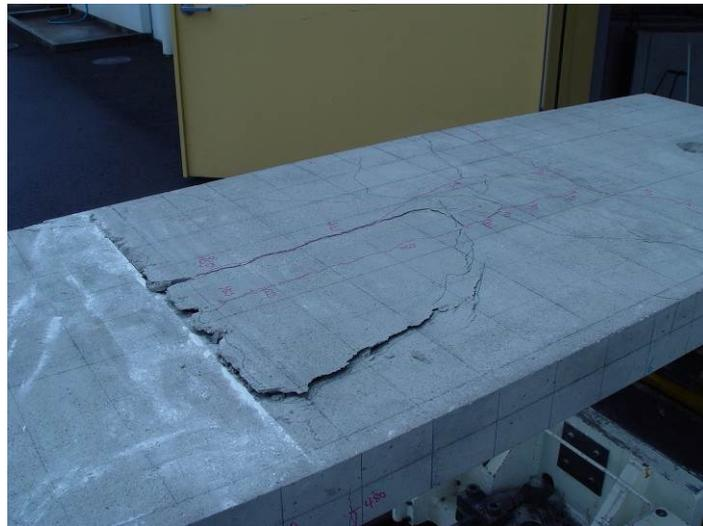
図 2-3-11 T-1 試験体のフランジ破壊状況
