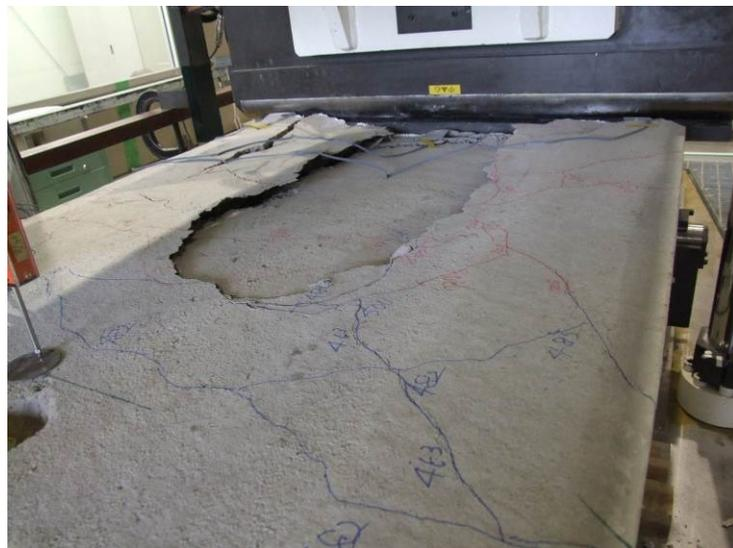
図 3-3-7 B-2 破壊時の上フランジのひび割れ状況
