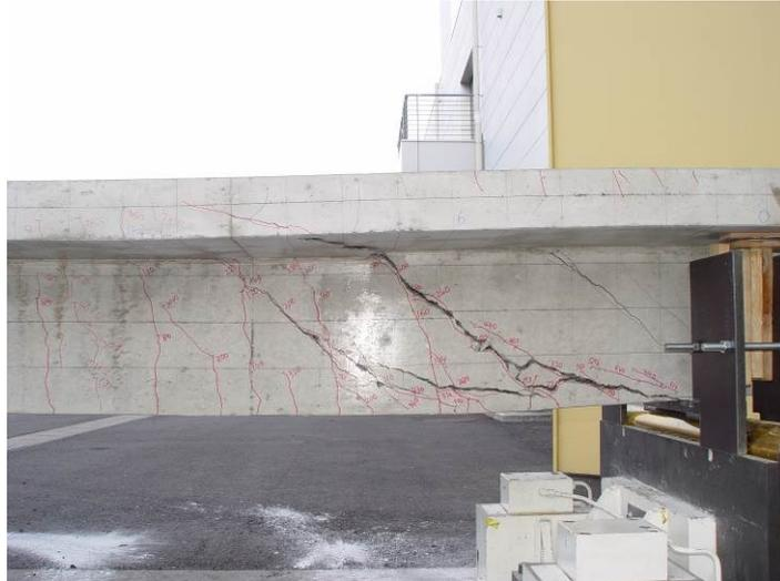
図 2-3-5 T-5 のウェブひび割れ状況
