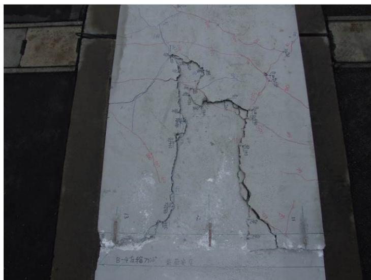
図 3-3-13 B-4 試験体の上フランジひび割れ状況
