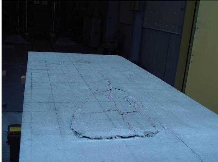
図 2-3-13 T-4 試験体のフランジ破壊状況
