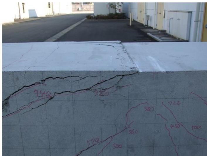
図 3-3-20 MA-2 試験体の上フランジひび割れ状況
