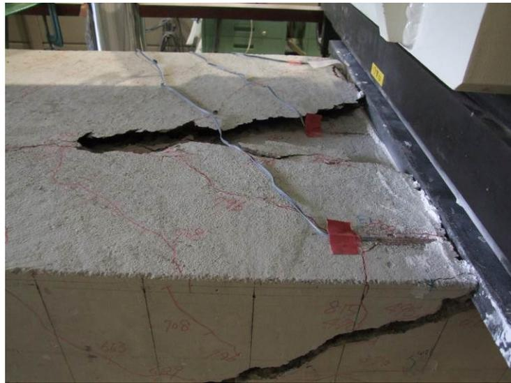
図 3-3-10 B-3 破壊時の上フランジのひび割れ状況
