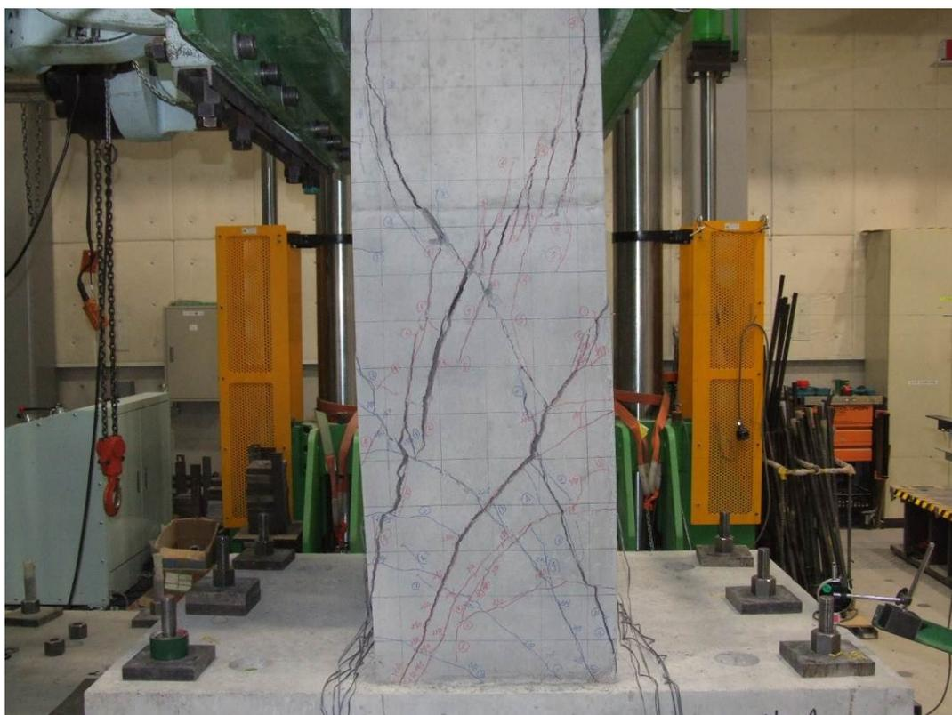
図 5-3-10 No.4 試験体終局時の破壊状況
