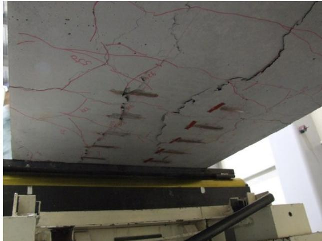
図 3-3-18 MA-1 試験体の下フランジひび割れ状況
