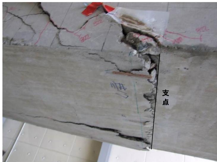
図 3-3-11 B-3 破壊時の下フランジのひび割れ状況
