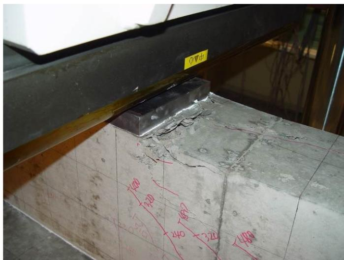
図 2-3-16 T-6 破壊時の状況 (圧縮域)
