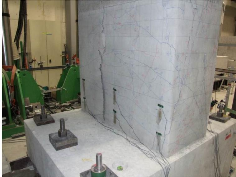
図 5-3-11 No.4 試験体載荷面の  $5\delta_y$  時点の状況
