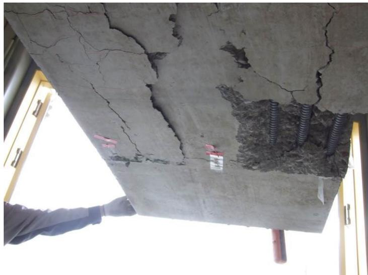
図 3-3-8 B-2 破壊時の下フランジのひび割れ状況
