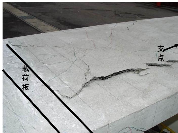
図 2-3-3 T-3 フランジのひび割れ状況
