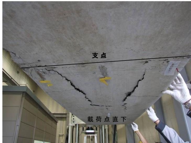
図 3-3-5 B-1 破壊時の下フランジのひび割れ状況
