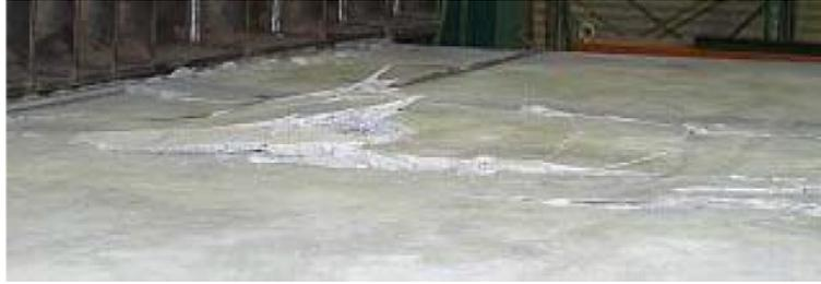
図 1-2-9 フランジ幅の広い試験体のフランジ破壊状況<sup>12)</sup>
