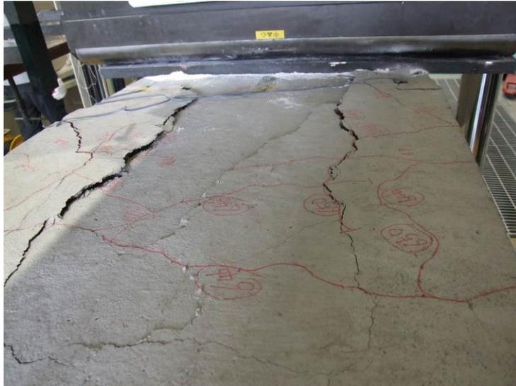
図 3-3-4 B-1 破壊時の上フランジのひび割れ状況
