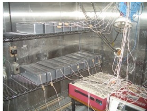
図 2.5.3 試験体の養生とひずみ測定状況
