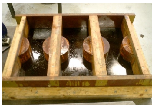
図 3.4.1 ダンベル型供試体の型枠
