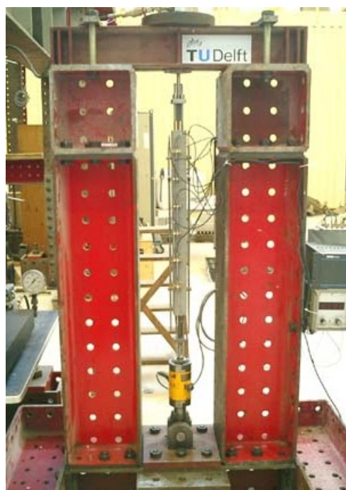
図 4.3.2 両引き試験の外観
