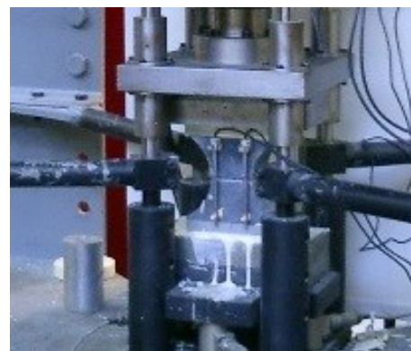
図 3.3.2 直接引張試験の状況
