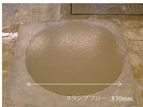
図 2.3.2 HPFRM のフレッシュ性状(スランプフロー試験「B130(0.8)-1」)
