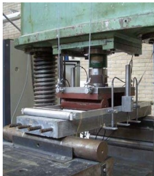
図 4.4.4 曲げ載荷試験の状況
