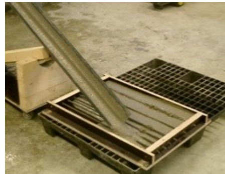
(1) x 配向 (鉄筋と平行方向) の打設方法
