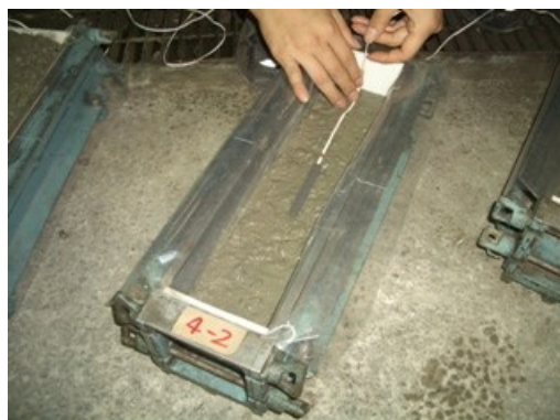
図 2.5.2 埋込型ひずみゲージの設置
