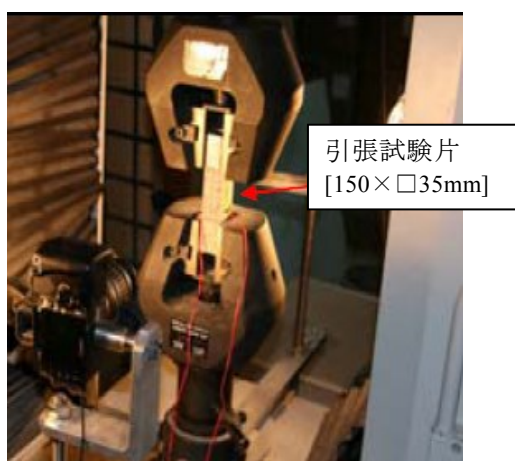
図 3.4.5 直接引張試験 (変位制御)
