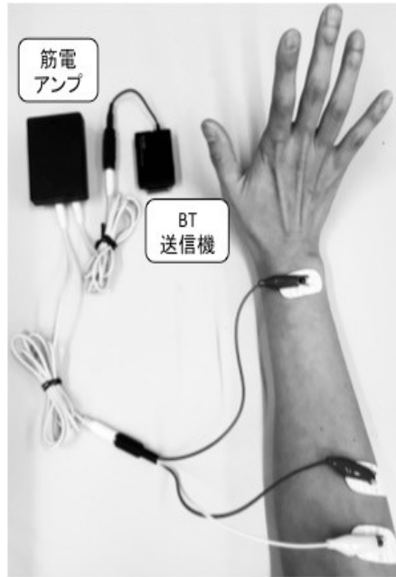
図 28. 送信機側の装置構成．[58]より引用．
