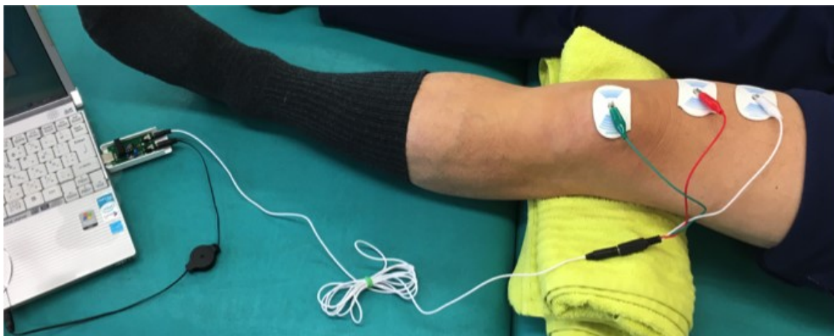
図 21. 低コスト EMG-BF 装置（村岡，2014）[43]を使用した筋電計測。
