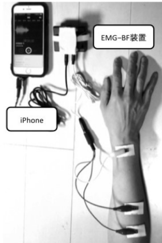
図 10. 低コスト簡易筋電計の構成。[45]より引用。
