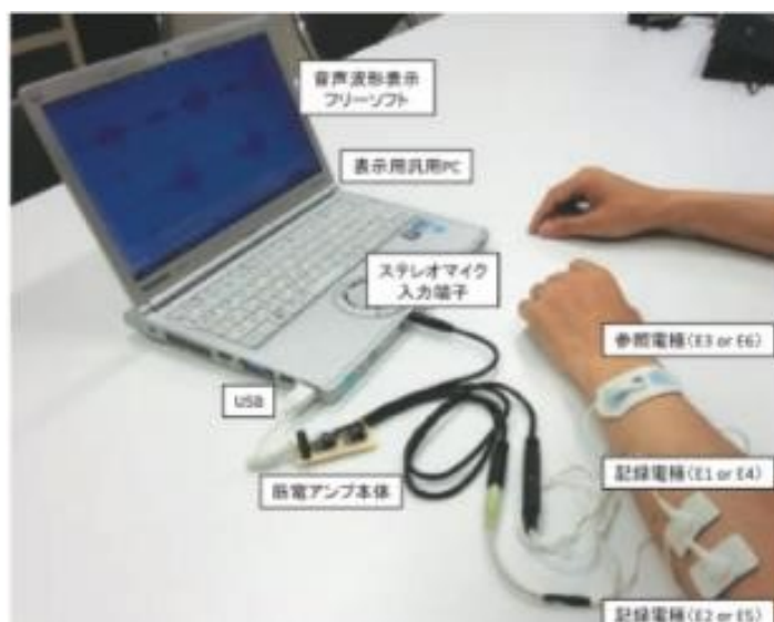
図 7. 低コスト EMG-BF 装置（村岡，2014）[43]より引用。
