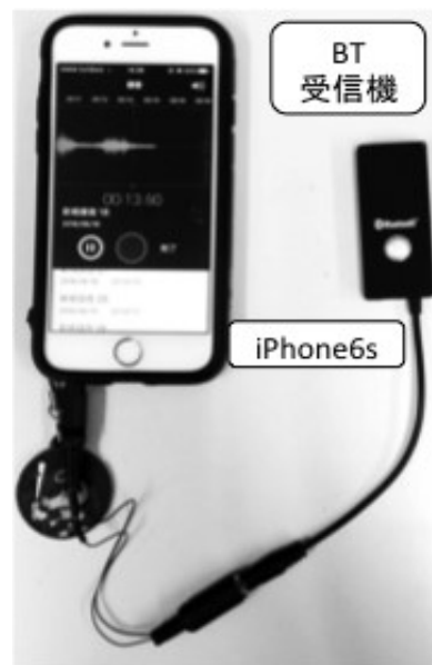
図 29. 受信機側の装置構成．[58]より引用．
