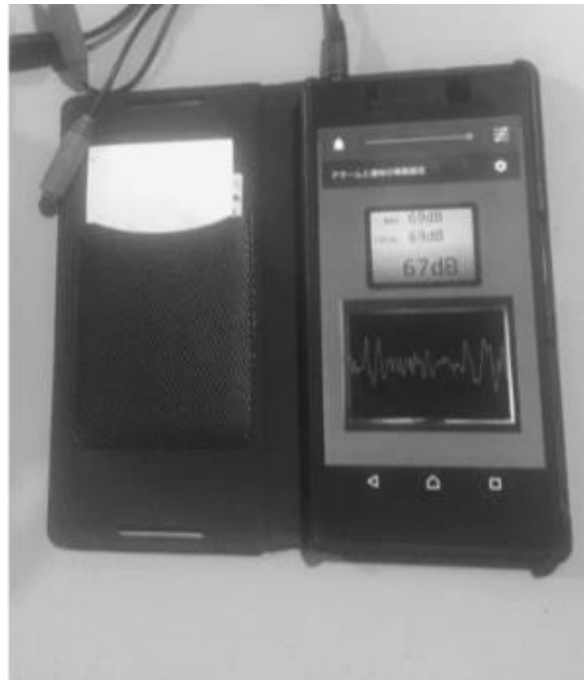
図 13. XperiaZ5 SOV32 での筋電波形表示。
