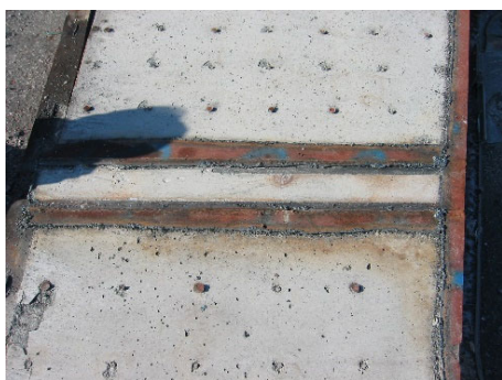
写真 2.2.9 モックアップによる充填度
