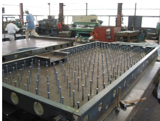
写真 2.2.7 パネルユニットの工場製作状況
