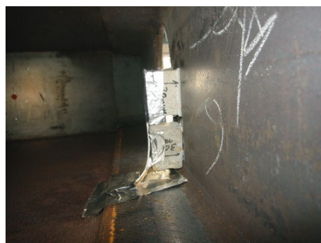
写真 2.2.10 鋼板内部の測定装置
