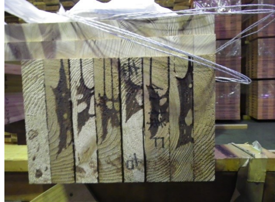
(2) 試験体中心部材断面（試験体 F）
