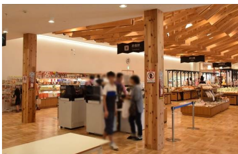
(1) 道の駅ふたつ（2018年3月竣工 秋田県能代市） ※手前に写る2本の柱が耐火構造部材である
