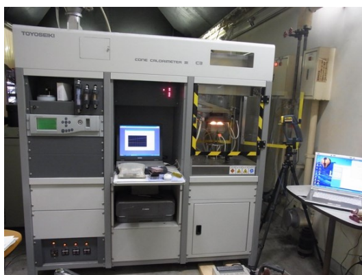
(1) 3分割された右端にコーンヒーター
