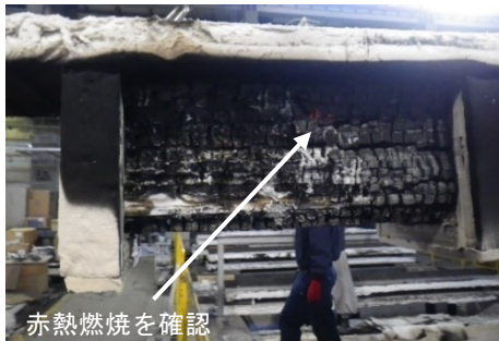
(2) 試験体 F (左：加熱面側面、右：加熱面下側)
