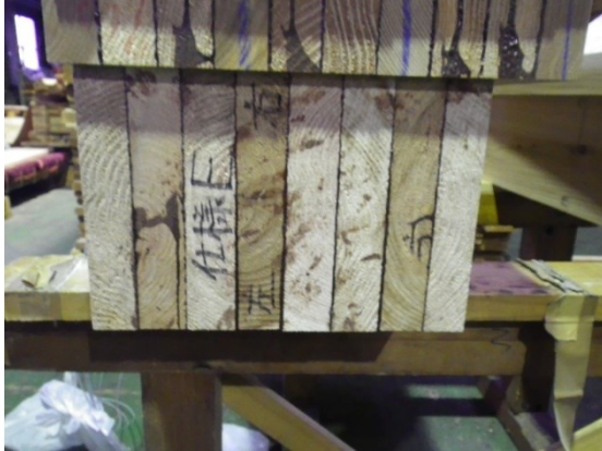
(1) 試験体中心部材断面（試験体 E）
