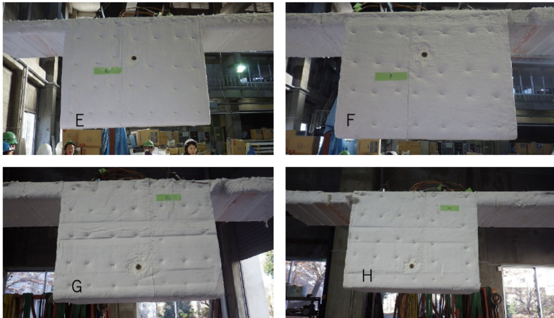
写真 3.2.3 熱流束計箱 (E~H の 4 体)
