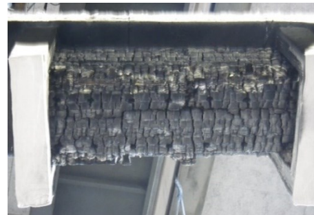
(2) 試験体 F (左：加熱面側面、右：加熱面下側)
