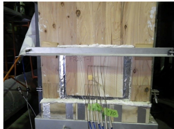
(2) 小型炉試験炉蓋及び試験体設置
