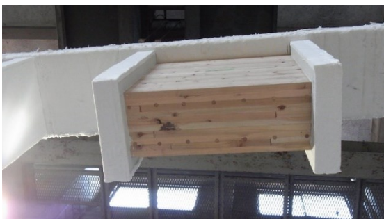
(7) 試験体加熱面下面 (試験体 G)
