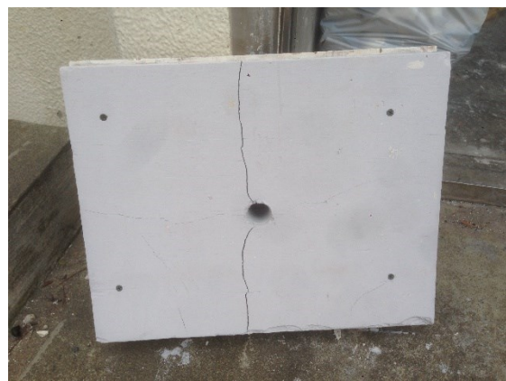
(4) 試験後加熱面の様子
