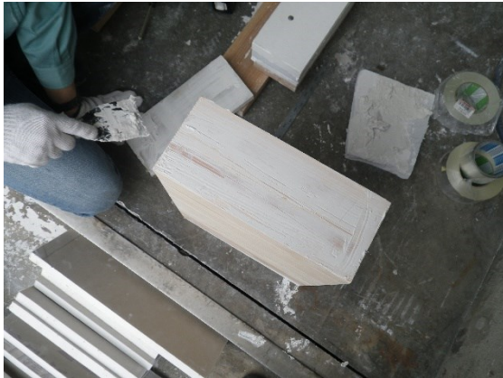
(1) 小型炉試験体 石こうボードの接着
