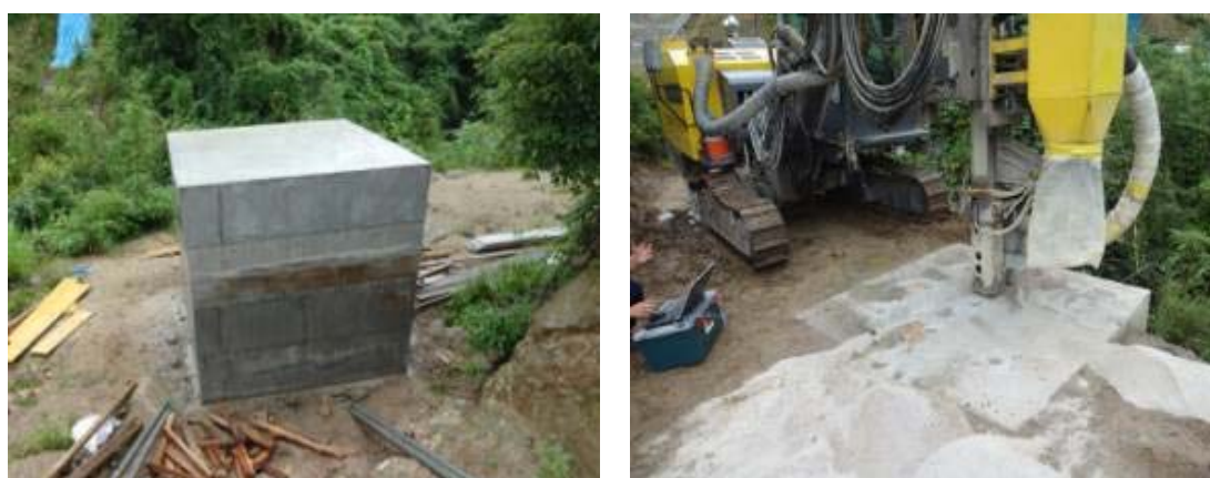
写真 4-1 層状コンクリート実験状況 (左：全景、右：削孔中)
