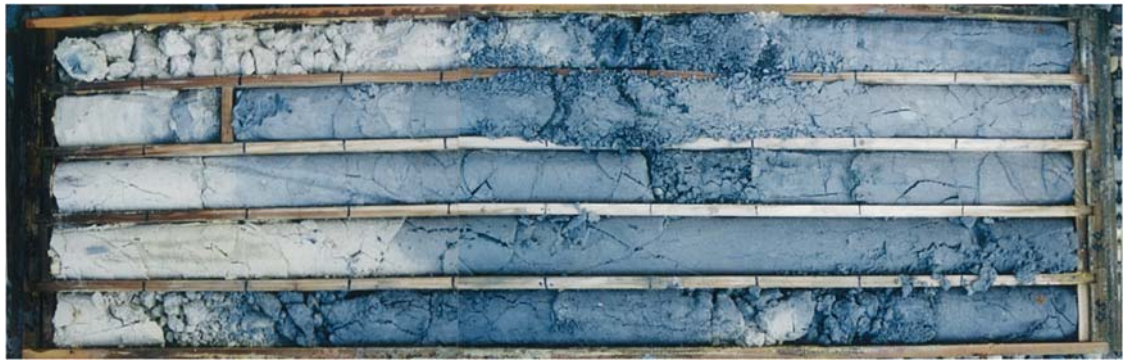
図 2-6 熱水変質で地盤が劣化した例 (ボーリングコア) 新第三紀中新世の火山碎屑岩
