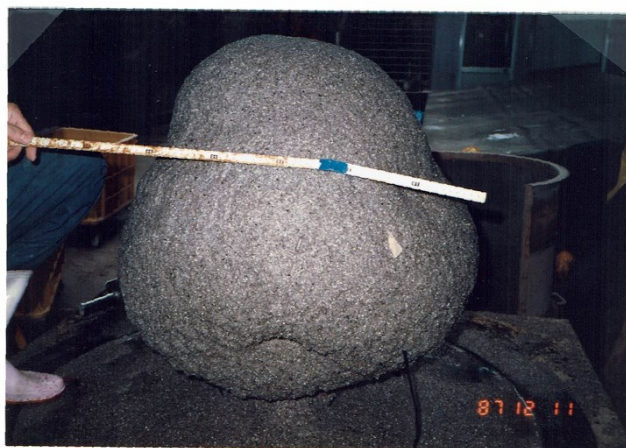
写真-4-1 瞬結性薬液注入での良好な固結形状①
