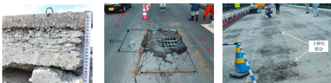
(a)実床版の切出し断面
