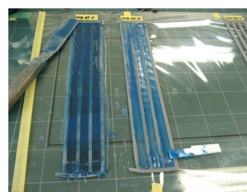
試験片を型枠に埋め込み
