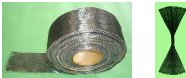
図 1.3.2 現場でCF アンカーを製作する方法 (例) 88)
