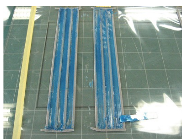
型枠に樹脂充填
