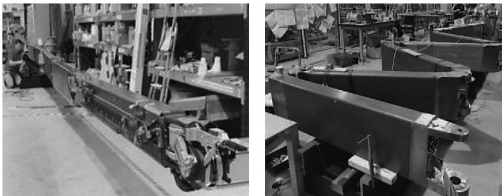
写真2 イギリスのベオリオ・ニュークリア・ソリューションズ（VNS）と三菱重工が共同開発した特殊鋼製ロボットアーム（長さ約22 m、重さ約4.6 t）
