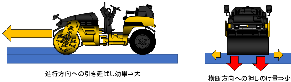
図 5.2-3 転圧ローラによる材料移動の概念図
