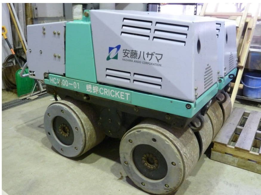
図 3.3-5 小型振動ローラ（HC1500-1）
