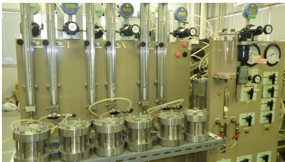
図 3.2-6 透水試験の状況
