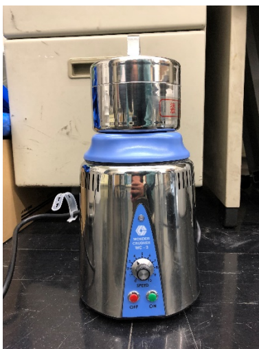
図 3-3 使用した破砕機
