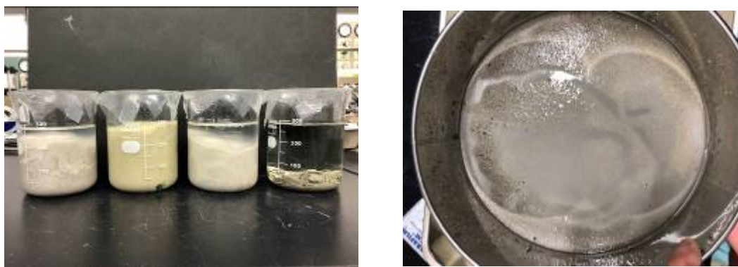
図 2-12 蒸留水中に静置した原鉍石試料の様子（左 4つの内、左から月布産，Ten Sleep 産，劉房子産）と劉房子産原鉍石の洗い出し中のふるい上残留分の様子（右）
