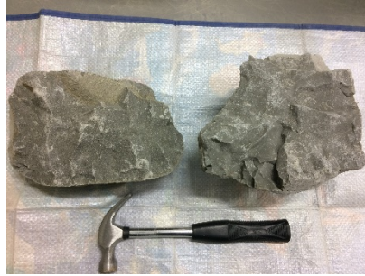
図 2-3 劉房子産ベントナイト原鉱石の様子
