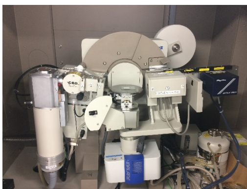
図 2-9 汎用多機能 X 線回折装置 (RINT-UltimaIII)
