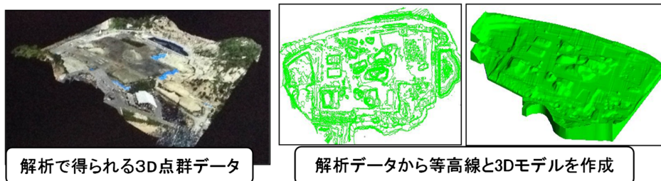
図 4.3.6 UAV オルソ測量からの 3D モデル作成プロセス
