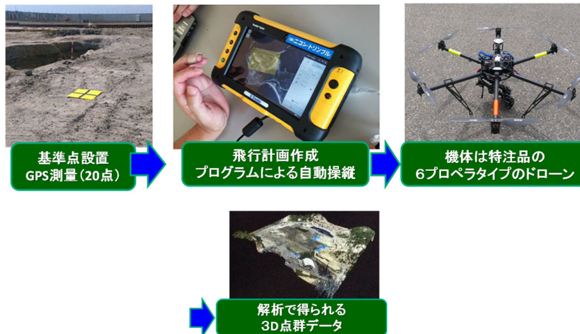
図 4.3.4 UAV による 3D 航空写真測量の概要
