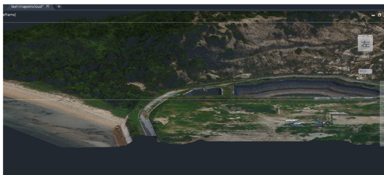
図 4.4.15 UAV オルソ測量による海水面・土堰堤内側の高度差、断面可視化
