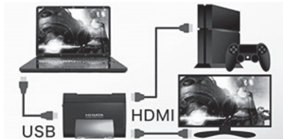
図5 キャプチャーボードの接続イメージ *I-O data GV-USB3 HD/E製品HPより
