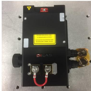
図 143 Yb:YAG Thin-disk 励起用 LD の外観
