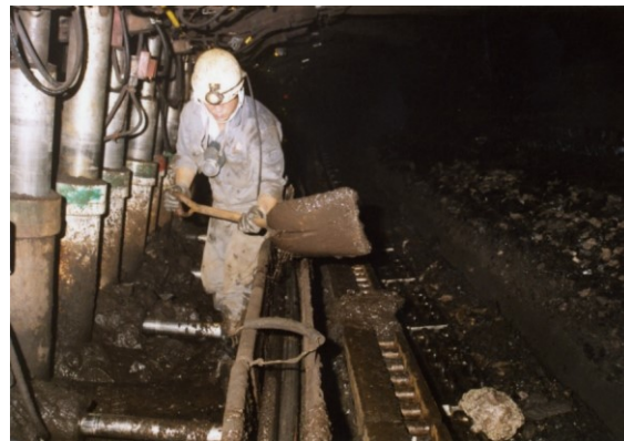
写真6-3 ズリ積み（1996年12月撮影）
