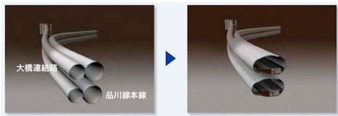
図 1.2.2-5 中央環状線品川線における連結路の構築
