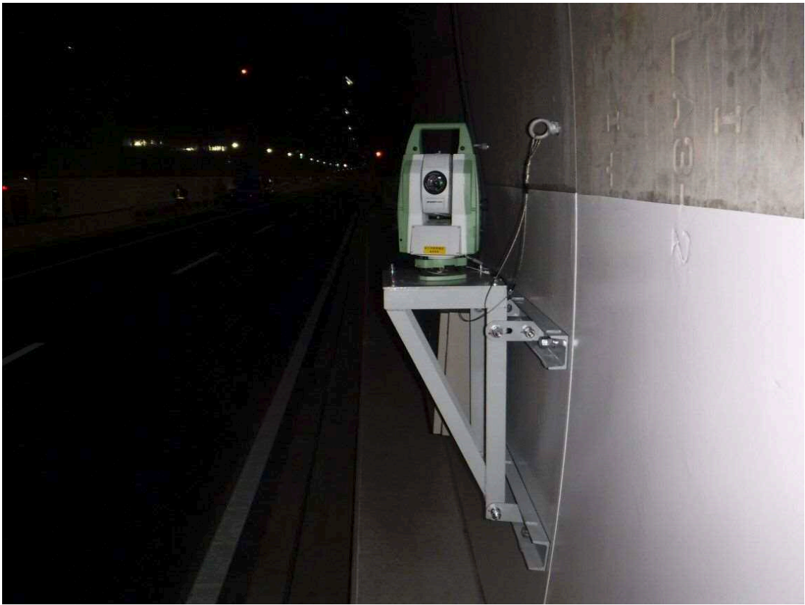
写真 3.4.6-3 本線トンネル内におけるトータルステーションの設置状況
