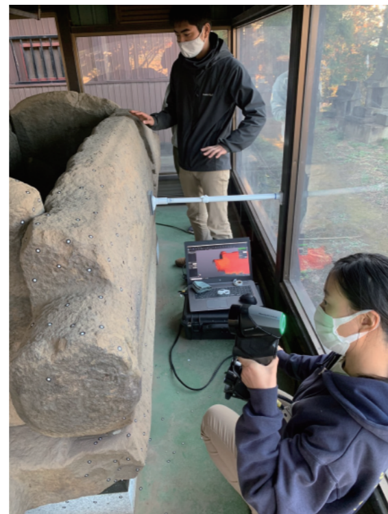
図2 Handy Scan を用いた三次元計測の様子
