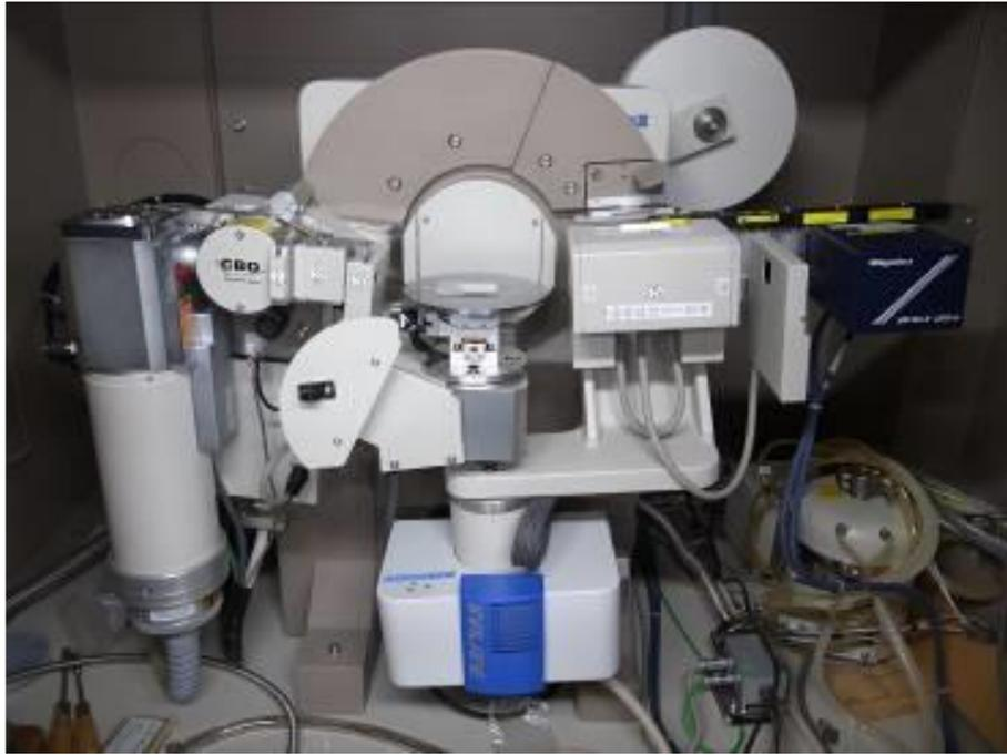
**Figure 3-15 XRD apparatus**
