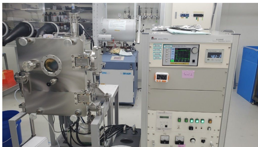
図 3.8 薄膜金配線作製に利用した真空蒸着装置
