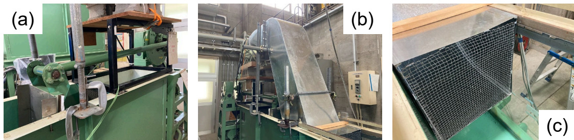
図-5.3 実験における外力(波・風)を生成する装置の写真。(a) フラップ式造波装置。(b) 送風ファンと水槽をつなぐチタン製のダクト。(c) ダクトの送風口に設置した乱流格子。
