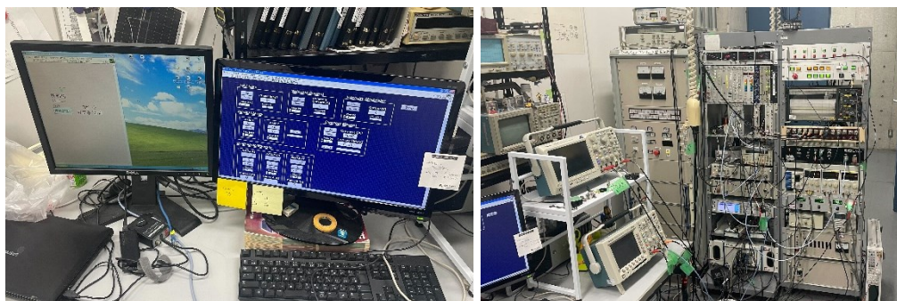
図 2.2 (左)制御 PC、(右)制御盤と LLRF システム
