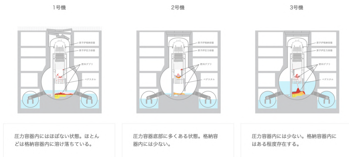
図 1-2 1F 1 - 3 号機における燃料デブリ分布の推定 [9]
