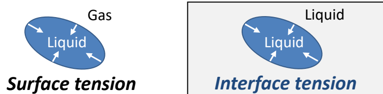
図 2-7 表面張力 (surface tension) と界面張力 (interface tension)
