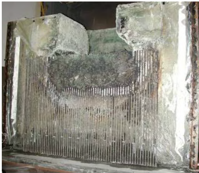
図 1-8 CCI-3 実験後のコンクリートと凝固したコリウム [22]
