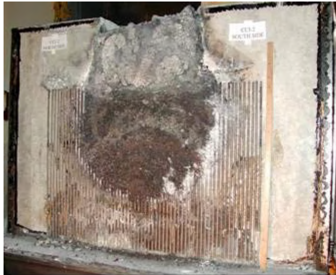
図 1-6 CCI-2 実験後のコンクリートと凝固したコリウム [22]
