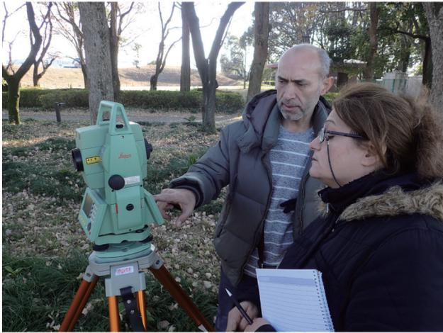
写真 11 TSを用いた基準点測量
